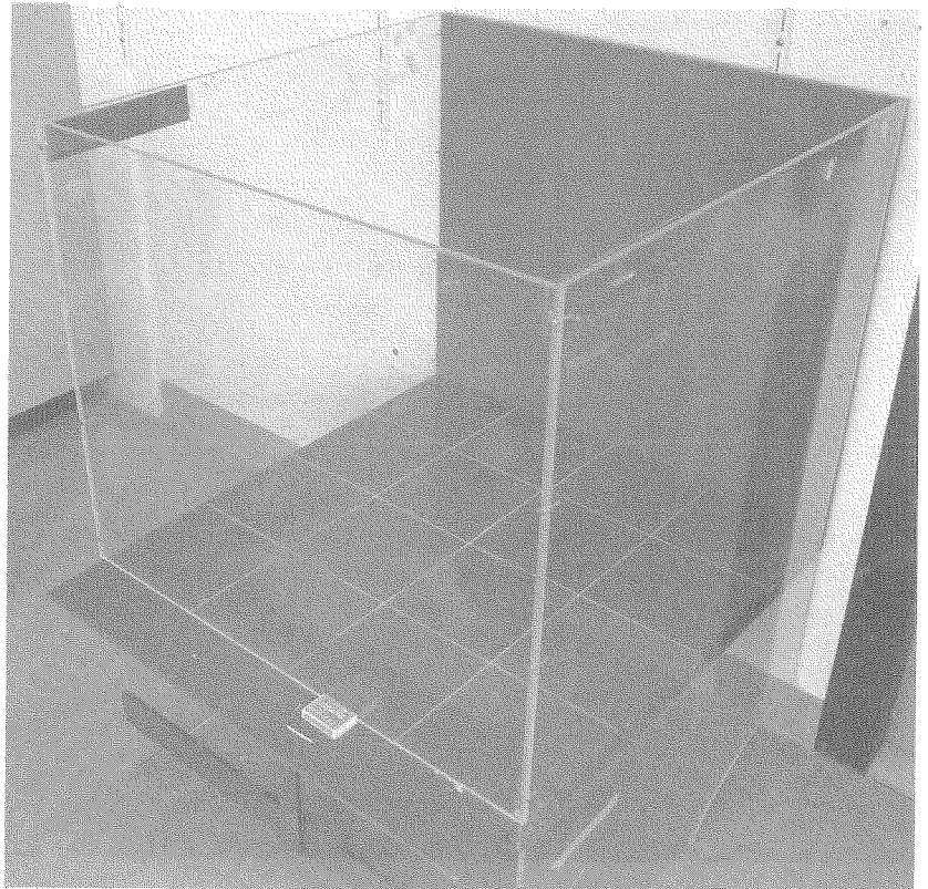
Afbeelding 1. De bak waarin het experiment werd uitgevoerd. Het vloeroppervlak is verdeeld in zestien compartimenten van gelijke grootte.
