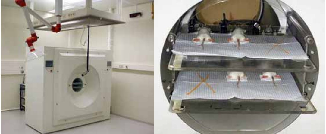
Afbeelding 1. HRRT op de linker afbeelding en de rechter afbeelding laat het 'muizenhotel' zien met de 2 perspex platen waarop de muizen liggen (maximaal 6 muizen tegelijk).
