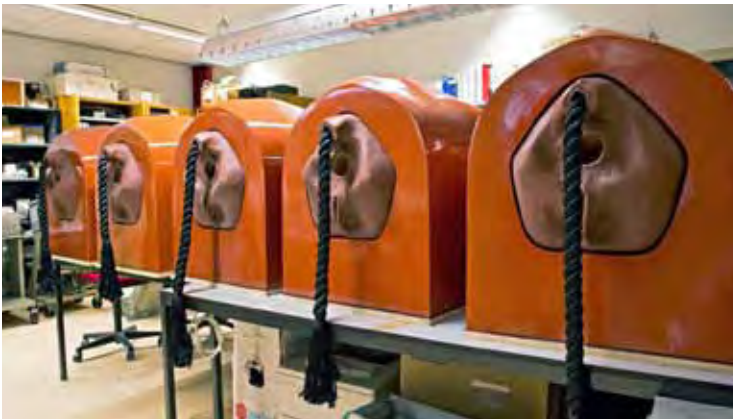
Afbeelding 8: Sensakoe. In de romp zitten namaakorganen van silicone. Ook zitten er druksensoren in, die in verbinding staan met een computer. Als een student in de koeienromp de organen bevoelt, wordt dat via speciale software vertaald naar een 3D-beeld op het beeldscherm. Zo leren studenten waar de organen zich bevinden in het koeienlichaam en hoe ze aanvoelen.
